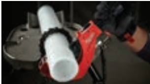
Se adapta para cortar PEX de 3" (76mm)
